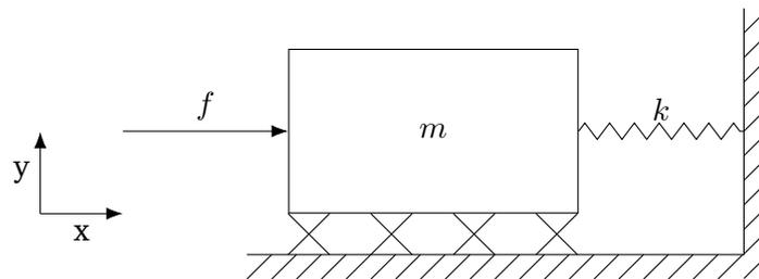
Abbildung 4.4: Lineares Feder-Masse-System
